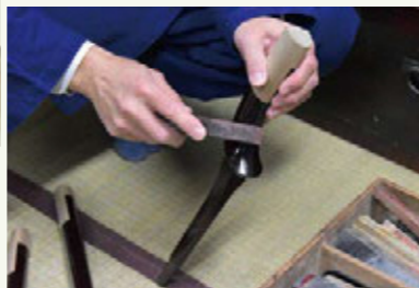
▲のこぎり、ちょうな、かんな、のみ、やすりなどを使って棹を作る。最後は砥石で磨き上げる。
